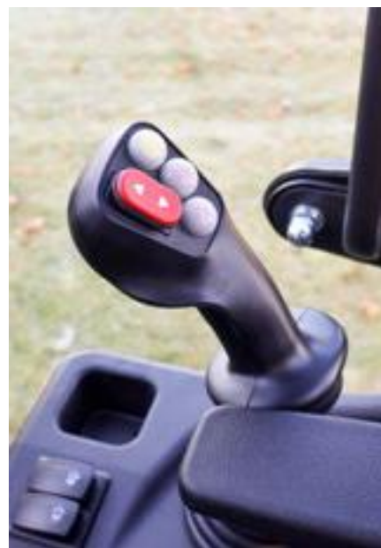
Ergonomisk lättmanövrerad joystick för lastaren med inbyggd fram- och backreglering. Elektrisk hög och låg samt möjlighet till elektrisk fjärde funktion via joystick.
