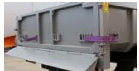
Topp-/sidohängd kombilucka med hydraulisk spridarläm. Levereras med kraftiga begränsningsband. Tillval MC11000–MC20000H.
