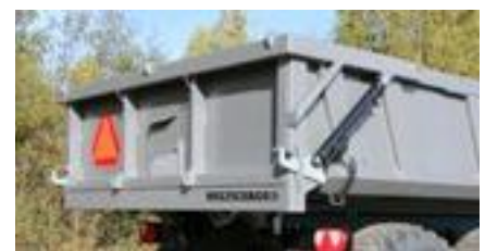
Hydraulisk uppåtgående baklucka. Standard MC16000H–MC20000H, tillval MC11000–MC16000R.
