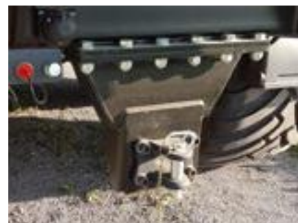
Bakre drag med broms-, el- och tipputtag finns som tillval till MC16–MC26R.
