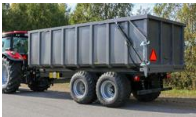
Modell MC20. Alla modeller standard med kraftig hydraulisk baklucka med dubbla lås. Spannmålslucka och LED-trafikbelysning är också standard.
