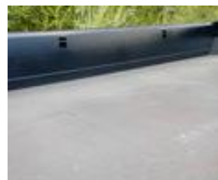
Slåta sidor med infälld lastsäkring. 10 cm Hardox® slitlist i sidor.
