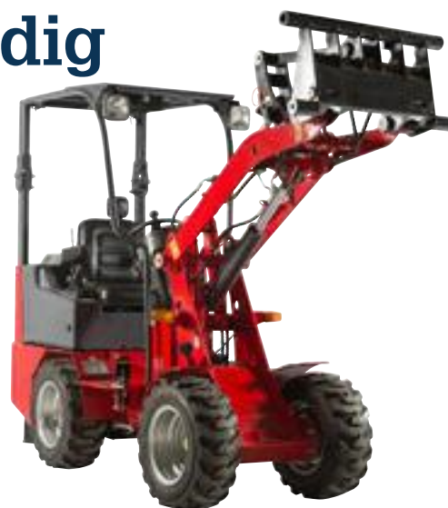
LRF – Bultat tak, fällbar skyddsbåge.
