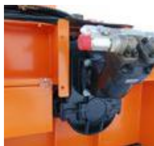
Hydraulmotor av koltyp är direktmonterad i växellådan. Anpassad för höga tryck och kontinuerlig drift. Avser modell 1802H–2452H.
