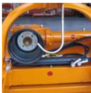
Kraftig transmission för 540 rpm. Hydraulisk sidoförskjutning finns som tillval.
