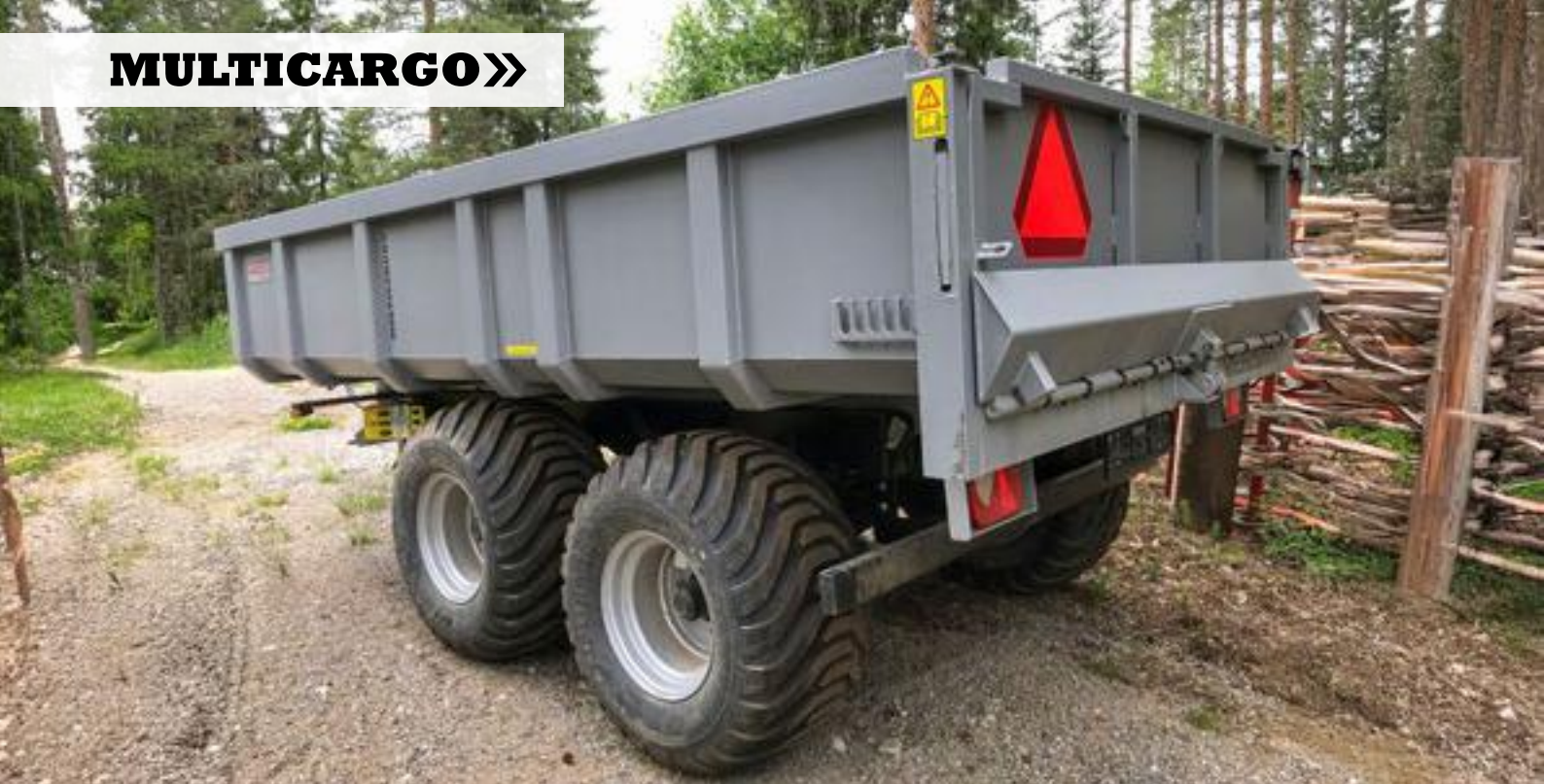
Modell MC11000 med hjul 520/50-17" och kombilucka med hydraulisk spridarläm.
