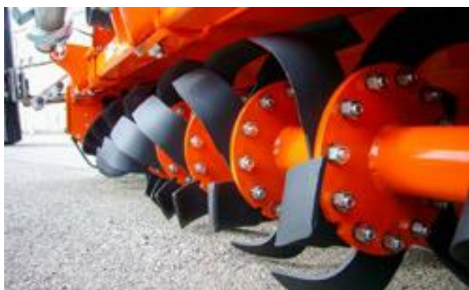
Kraftig rotor med bultade knivar i spiralform.
