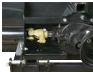
Modeller för upp till 2 000 varvs PTO. Brytbult skyddar inmatningen.
