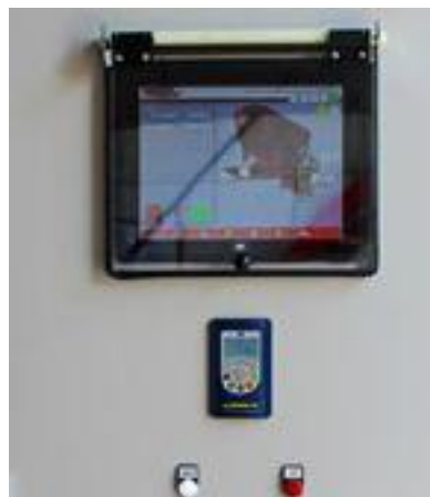
Trioliets touch-styrsystem levereras med en 8,2" touchskärm och kan utrustas för att kontrollera de flesta externa tillbehör.
