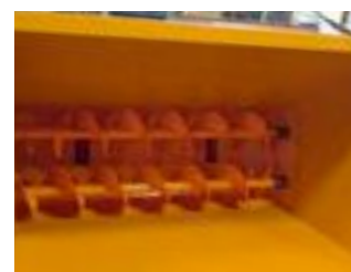
BS-skopan har två fördelningsvalsar med justerbara flödesplåtar
