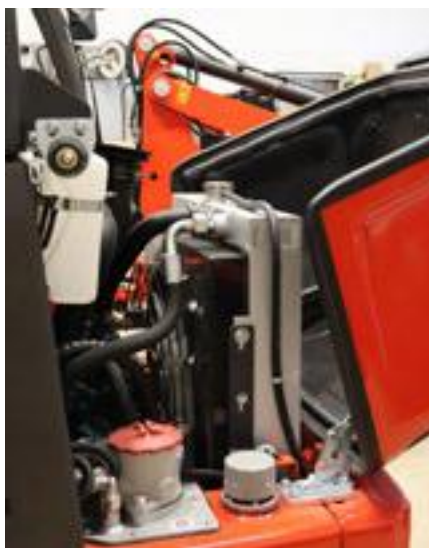
Bra åtkomst för underhåll och service med öppningsbar huv, bultade sidokåpor samt fällbar stol. Väl tilltaget kylpaket för både hydraulik och motor.
