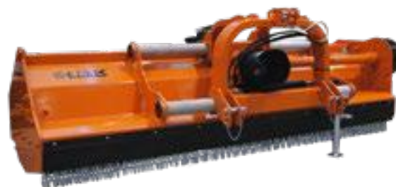
Modell LAND-S är standardutrustad med stora stödhjul, hydraulisk sidoförskjutning och dubbel chassi i Strenx®-stål.
