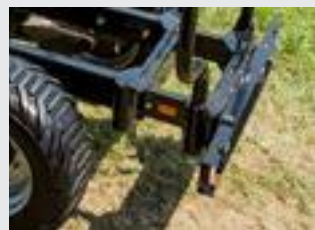
Ramförlängning 625 mm, två stöttor ingår.
