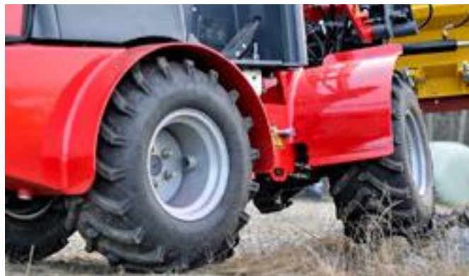
En ledad midja ger fler däck i ingrepp i kuperad terräng. Trejon Flexitrac kompaktlastare är utrustade med rejäla däck. Vid behov finns fler alternativ.
