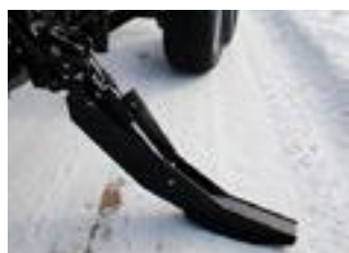
Lavettstödben med stor stödbredd anpassade för större kranlängder.
