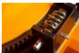
Snäckväxel är standard på samtliga Trejon Optimal snöfräsar. Denna är självrensande och håller utkastarröret låst i önskat läge.
