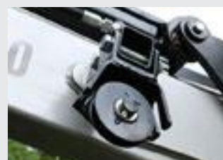
Brytblock på kranen ger ökad dragvinkel.
