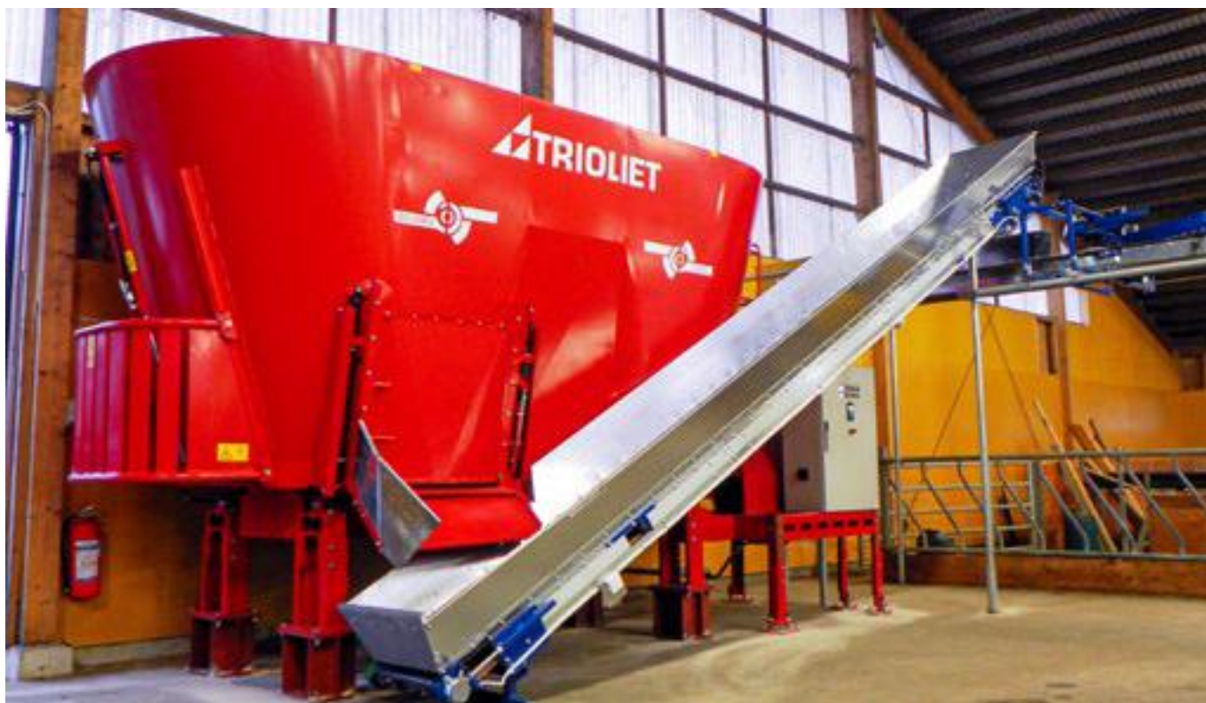
Trioliets stationära blandare kan enkelt kombineras med olika utfodringssystem, exempelvis som bilden visar med bandfoder.
