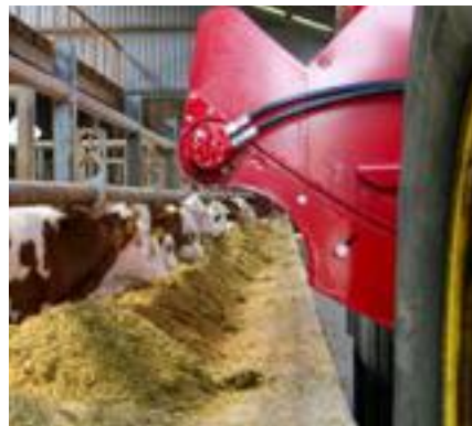
Den hydrauliskt utskjutbara VLH-C-kedjeelevatoren lämpar sig ypperligt vid utfodring över krubbkanter.
