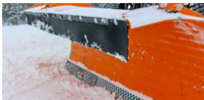
Kastskyddet i gummi minskar risken för att snö sköljer över plogen och försämrar sikten.
