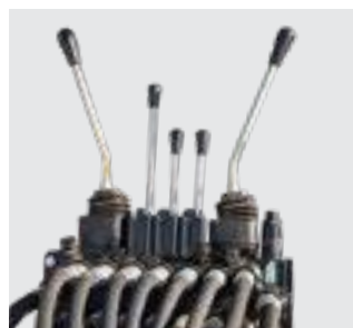
Mekaniskt ventilpaket med koordinatspakar.
