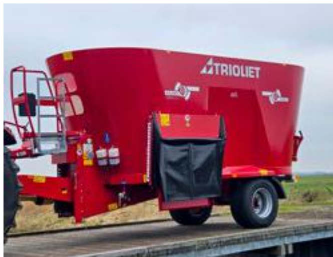
Solomix 2400 ZK i utförande med hydrauliska sidoluckor.
