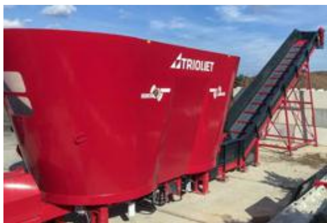
Trioliet har ett brett utbud av stationära elevatorer för högre lasthöjd och kapacitet. Det går att kombinera med en stationär blandare med utmatning antingen i gavel eller sida.
