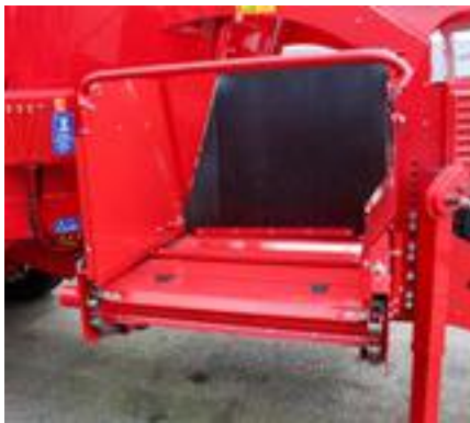
Plana kedjeutmatningselevatore går att få fram eller bak.
