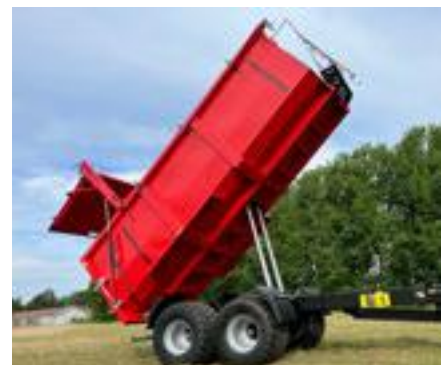
Hög tippvinkel för enkel urlastning och kraftig ramkonstruktion för lång livslängd.
