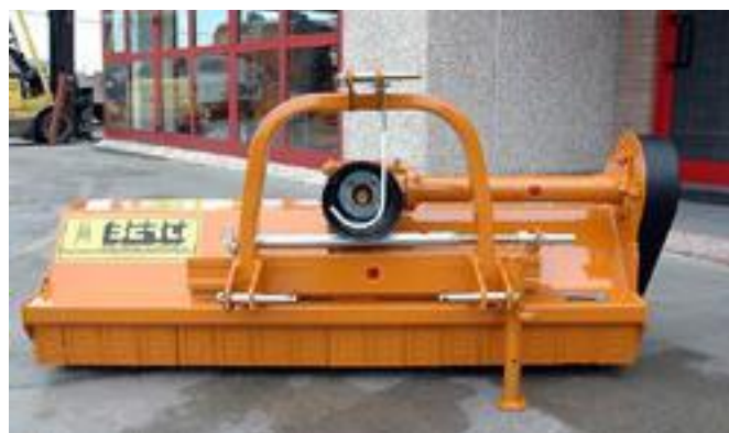
Berti modell PARK-P 145 här standardutrustad med mekanisk sidoförskjutning.
