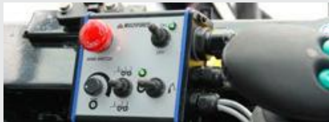
Kontrollventil EHC Ergo Pro. 6 proportionella + 2 el on/off.
