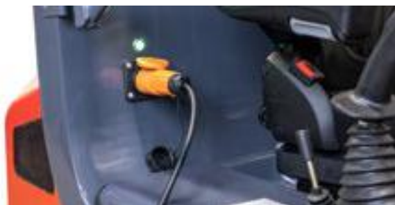
Integrerad 230V-laddare som standard med en laddningstid på 6–8 timmar.
