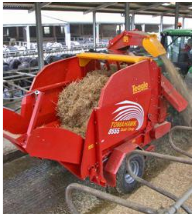
Modell 8555 med Dual Chop-system kan användas för att ströa djupströbedd såväl som likt bilden liggbås.
