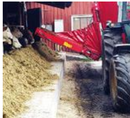
Helt hydrauliskt ställbar kedjeelevator 0,6–2,1 m finns som tillval.
