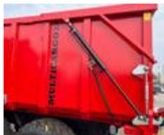
Alla modeller standard med hydrauliskt uppåtgående baklucka med kraftig dubbel mekanisk låsning.
