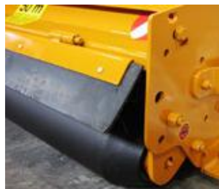
Berti DUAL standard med dubbelchassi, kraftig bakre stödrulle och glidmedar.
