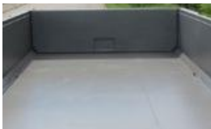
Slät insida och 45° vinkel mellan sida och botten. Invändiga fästöglor för lastsäkring.
