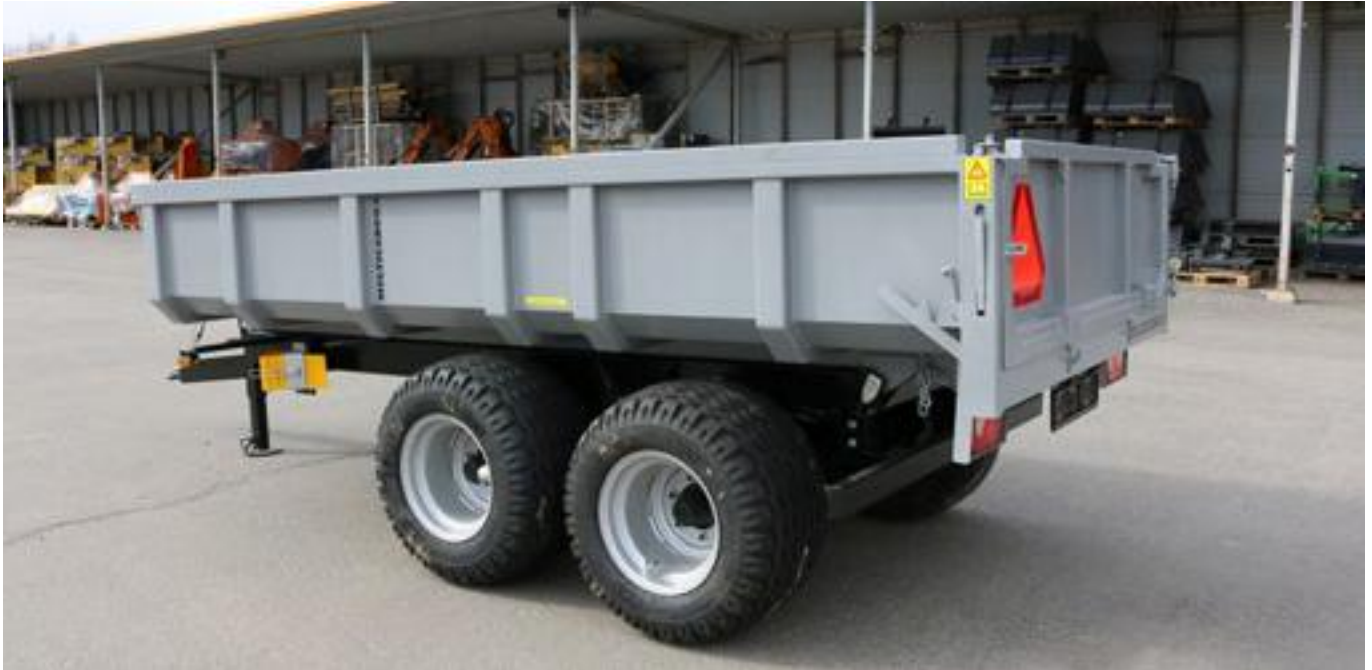
MC9000 med hjulutrustning 19/45-17".
