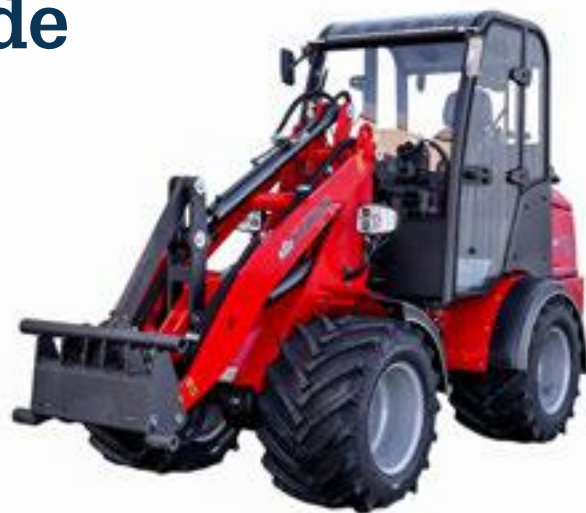
LRF-modellerna har bultat tak och fällbar skyddsbåge.
