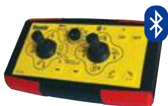
Trådlös elektronisk manövrering via Bluetooth.
