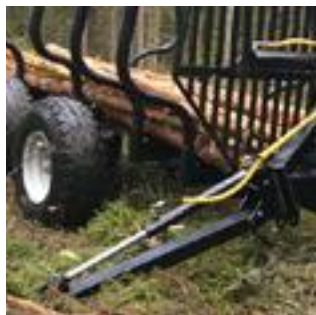
3-punktsstativ med integrerade lavettstödben.
