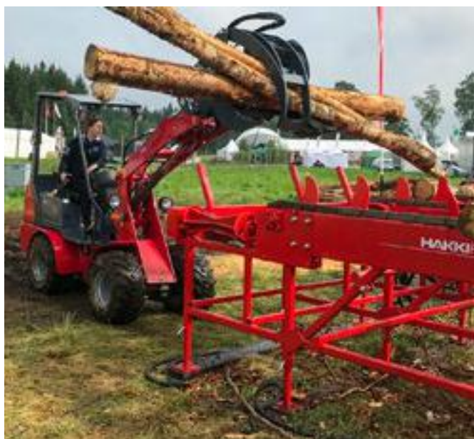
Trejon Multiforest timmergrip – det perfekta redskapet för att exempelvis lasta ett uppläggningsbord.
