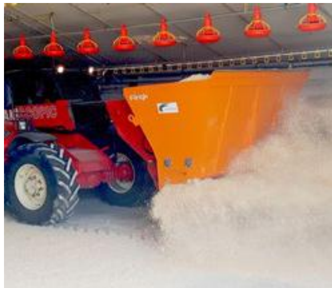
Flingk BS1000 med spridartallrikar för jämn fördelning av fint material.
