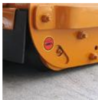
Klipphöjden regleras med maskinens stödrulle som är justerbar i höjddled.
