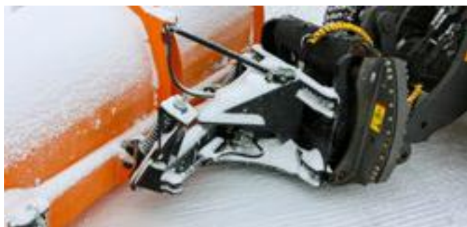
Flytfäste där plog och skär rör sig i en enhet – uppåt/bakåt.
