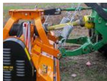
Kraftiga avlastningsfjädrar för optimalt marktryck. Maskinen levereras med Walterscheid kraftaxel.
