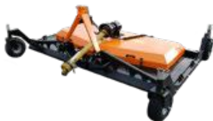
Trejon Optimal BP275 med fyra pivoterande stödhjul.
