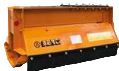
TFX-SB för grävmaskiner mellan 11–16 ton är likt PARK-FX och ECF-SB anpassad för tuffa skogsarbeten.
