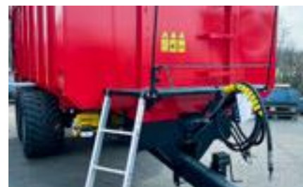
Plattform med steg och räcke finns som tillval till MC16–MC26R.
