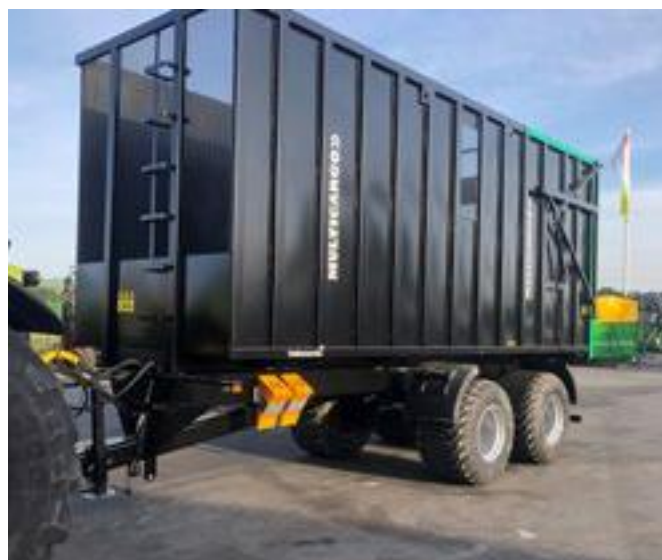
Modellen MC40 är speciellt framtagen som ren ensilagevagn med siktgaller fram, bak och på sidorna. Med en volym på hela 40 kubik och stora 710/45R-22,5" hjul är den optimal för en effektiv grässkörd.
