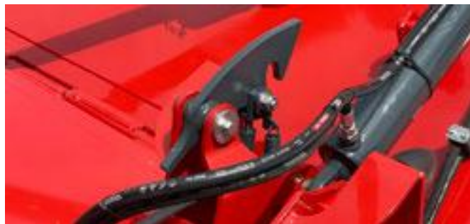
Hydraulisk låsning i transportläge som standard.
