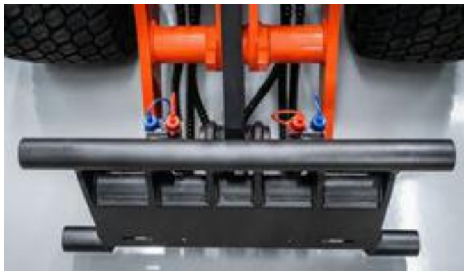
Redskapsfäste med Trima/SMS samt hydrauliskt redskapslås av redskapet är standard. 3:e funktion är standard, 4:e finns som tillval.
