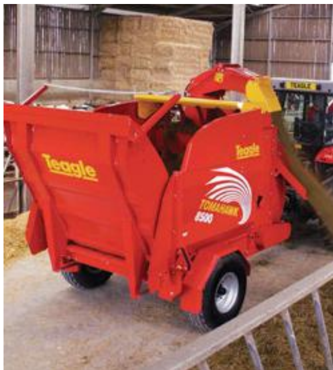
Modell 8500 är bogserad och har en extra bred rivartrumma. Här används den för att utfodra ensilage.
