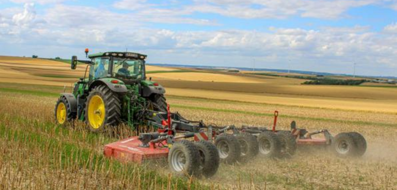
Sauerburger Condor 7300 i standardutförande med åtta hjul i tandem.
