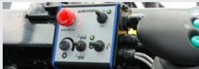
Kontrollventil EHC Ergo Pro. 6 proportionella + 2 el on/off.
