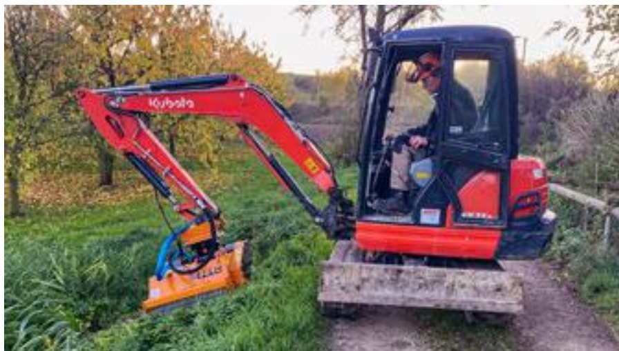
Berti CKT-SB är ett mångsidigt och kompakt hydrauliskt klipphuvud för minigrävare mellan 4,5–5,5 ton.
