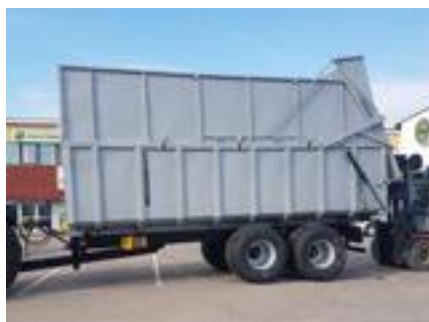
Förhöjningslämmar monteras som en hel kassett fäst med vagnslås som kan lyftas av som en enhet.
