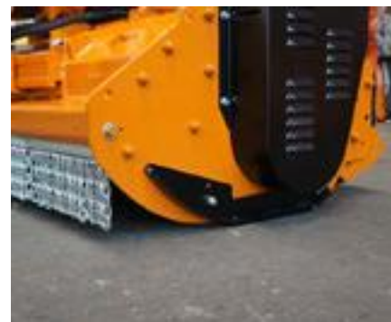
Standardutrustad med glidmedar i Hardox® vilket skyddar maskinen och minskar risken för kalkklippning. Hydraulisk sidoförskjutning och automatisk remspänning följer med som standard.
