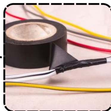
Fixação de componentes e isolamento de fios
