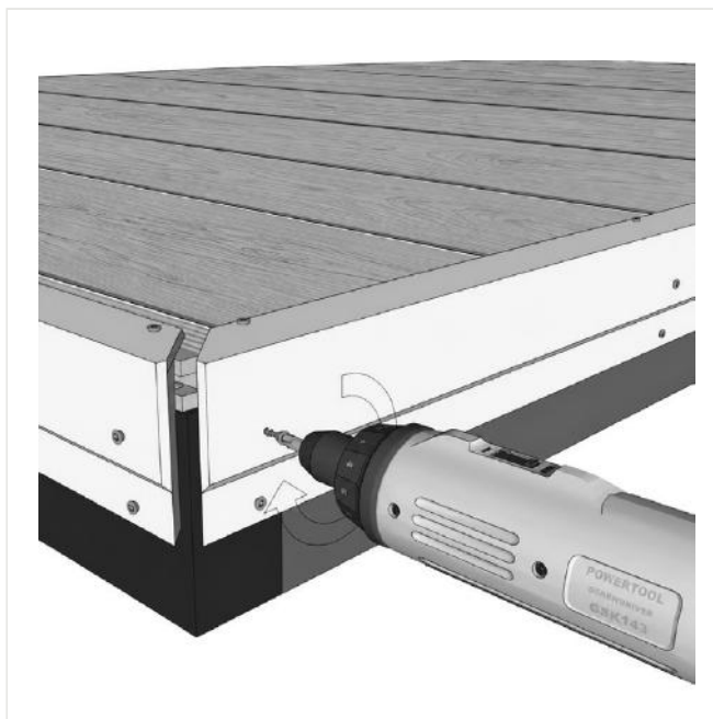
FIG. 26 – HOEKPROFIEL BEVESTIGD MET VERZONKEN SCHROEVEN
