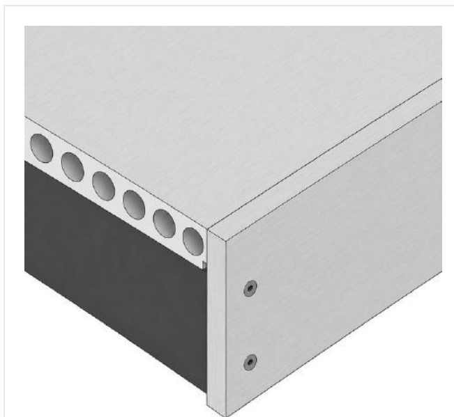
FIG. 24 – VERZONKEN VOORBOORGATEN VOORGEBOORD DOOR HET BOEIBOORD
