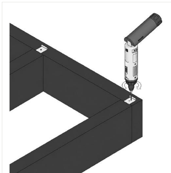
FIG. 17 — RANDPLANK — STARTCLIPS OP DE BUITENSTE REGEL
