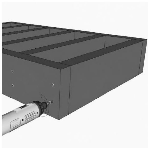
FIG. 27 — KADERFRAME GEBOUWD OM HET TREDENGEBIED TE ONDERSTEUNEN
