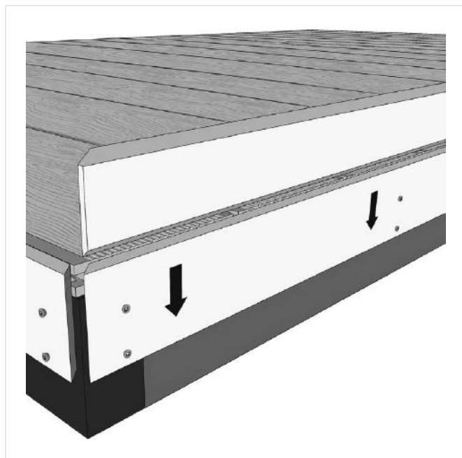
FIG. 25 – HOEKPROFIEL OVER DE TERRASRAND GEPLAATST
