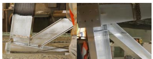
การชุบแบบจุ่มสองครั้ง จะมีรอยกับซ้อนของการชุบที่ชิ้นงาน
