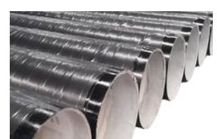
ท่อเหล็กตะเข็บเกลียว เคลือบโคล์ทาร์ ภายนอกและเคลือบซีเมนต์ภายใน Outside Coating: COAL TAR WRAPING Outside Standard: AWWA C203 Inside Coating: Cement mortar Inside Standard: AWWA C205
