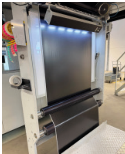
Abbildung 3 Vollflächiger Druckabzug mit Schwarz nach dem Umwaschen.
