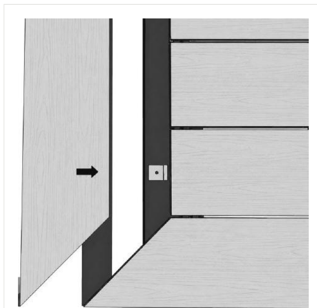
FIG. 15 - TABLA DE CENEFAS PERIMETRALES DESLIZADA DENTRO DE LOS CLIPS DE INICIO
