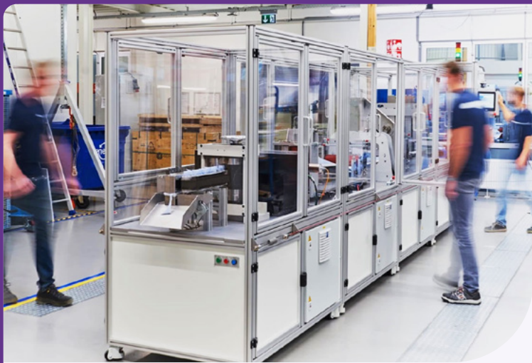
Door Demcon in eigen huis ontworpen machine voor snelle productie van FFP2-mondmaskers.
