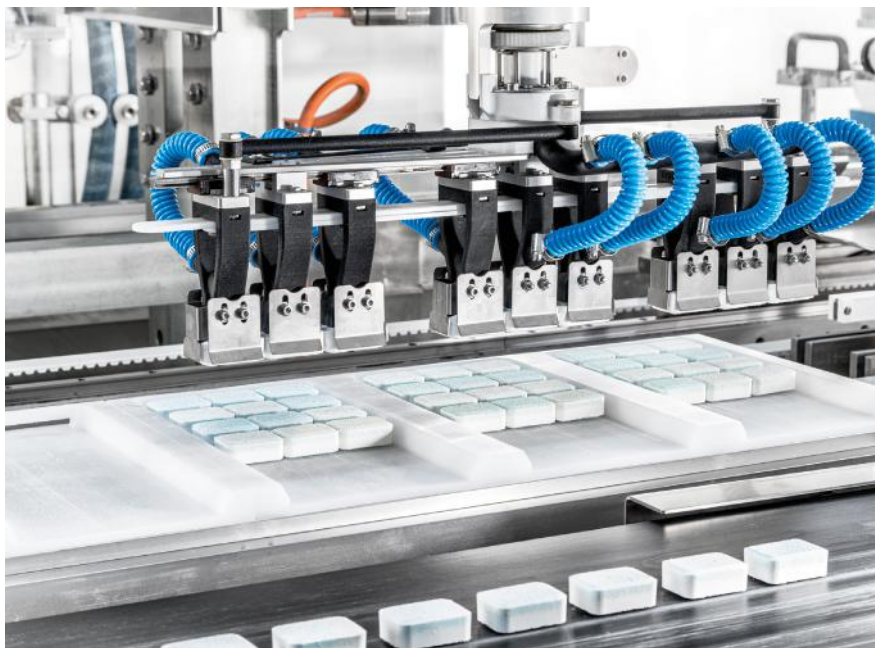
Befüllte Trays verschließen Roboter mit Deckeln – die staubdichte Verpackung steht.
