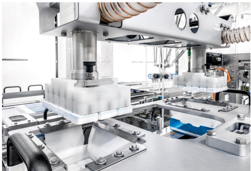
Roboter füllen die Tabs passgenau in die Trays.
