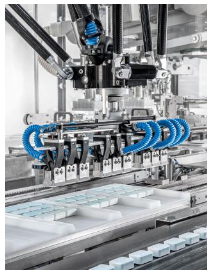
Ein Delta-Roboter gruppiert die einlaufenden Tabs vor.
