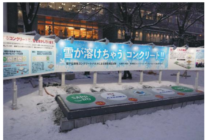
Fig.2: Demostración de paneles de autocalentamiento EC 3 en Odori Park en Sapporo, Japón. (foto cortesía de MITEC 3 y Aizawa Concrete)
