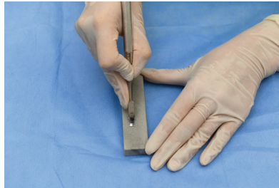
Resim 65 • Keski ve çapa şeklindeki kazıyıcılar çekme hareketiyle keskinleştirilirler.
