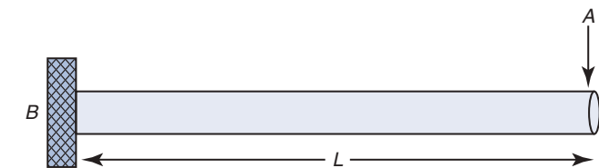
Şekil 6.17 Serbest uç olan (A) noktasında yük ( L ) uygulanan bir kantilever (B)
