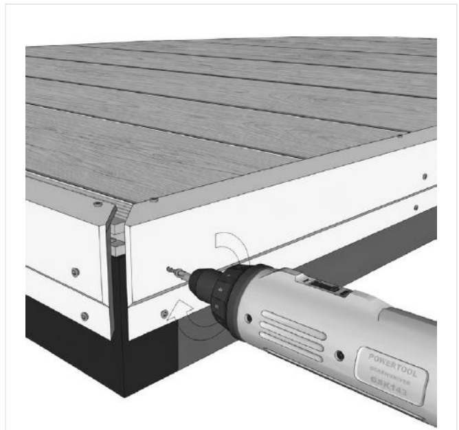
FIG. 26 – ECKPROFIL MIT GESENKTEN SCHRAUBEN BEFESTIGT
