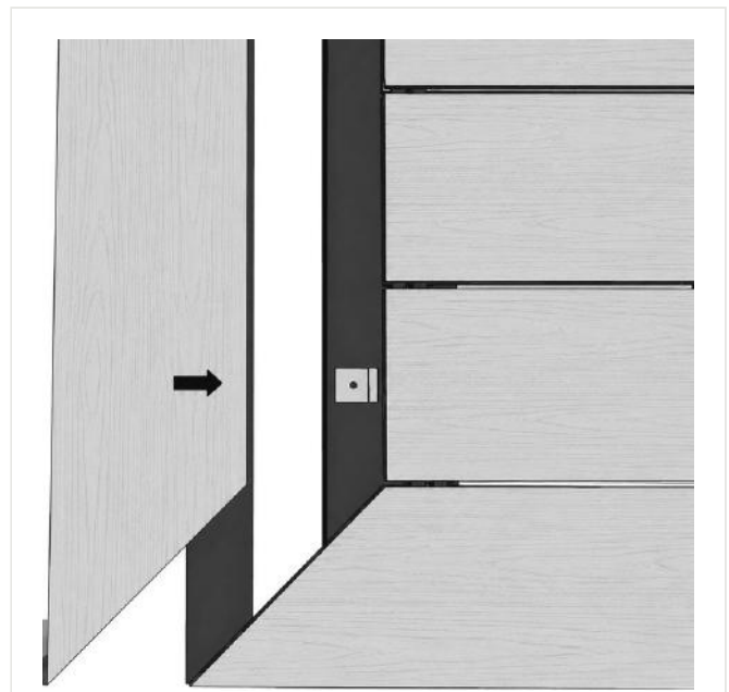
FIG. 15 – RAHMENBORDÜREN-DIELE IN DIE STARTCLIPS GESCHOBEN
