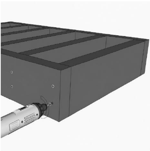
FIG. 27 – KASTENRAHMEN ZUR STÜTZUNG DES STUFENBEREICHS GEBAUT
