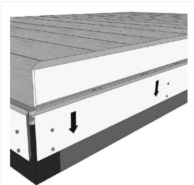
FIG. 25 – ECKPROFIL ÜBER DIE TERRASSENKANTE GELEGT
