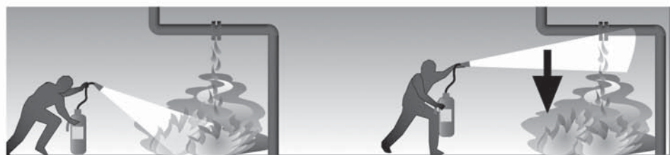
Aber: Tropf- und Fließbrände von oben nach unten löschen
