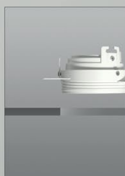
NIVELAR Y FIJAR CON TORNILLOS
