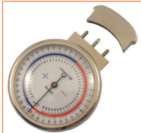
Resim 2.6 • Mercek saati (sferometre)
