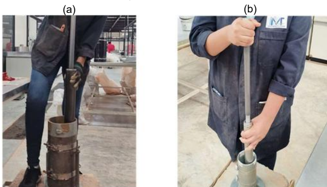
Figura 5. Compactación de las muestras. (a) Muestras de 15 cm de diámetro y (b) Muestras de 7,1 cm de diámetro.
