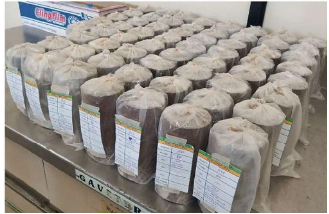
Figura 6. Muestras colocadas en bolsas de plástico y curadas durante 7 días.
