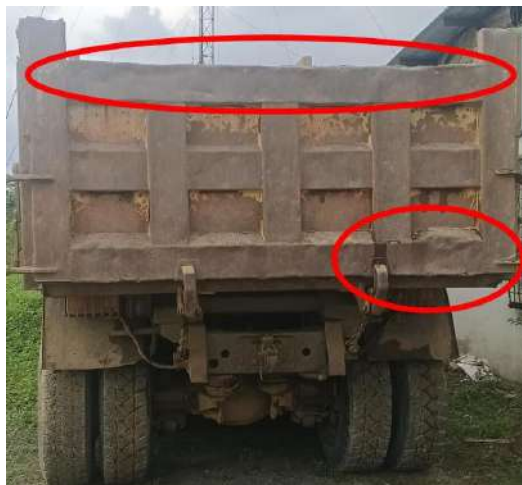
Foto 7: Puerta de balde de volqueta presenta deformaciones, abolladuras en diferentes partes de la estructura.
