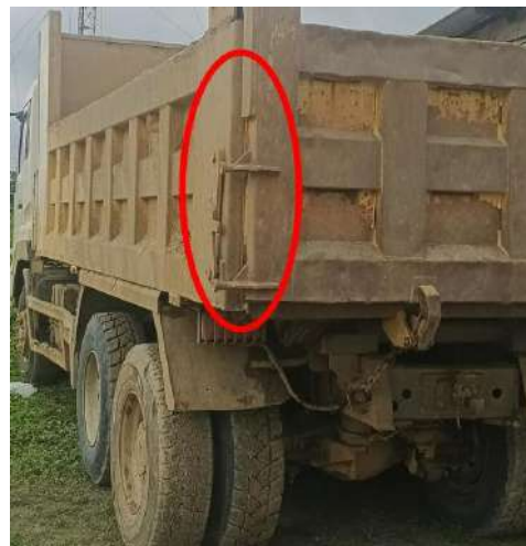
Foto 8: Puerta de balde de volqueta presenta deformaciones, abolladuras en diferentes partes de la estructura.
