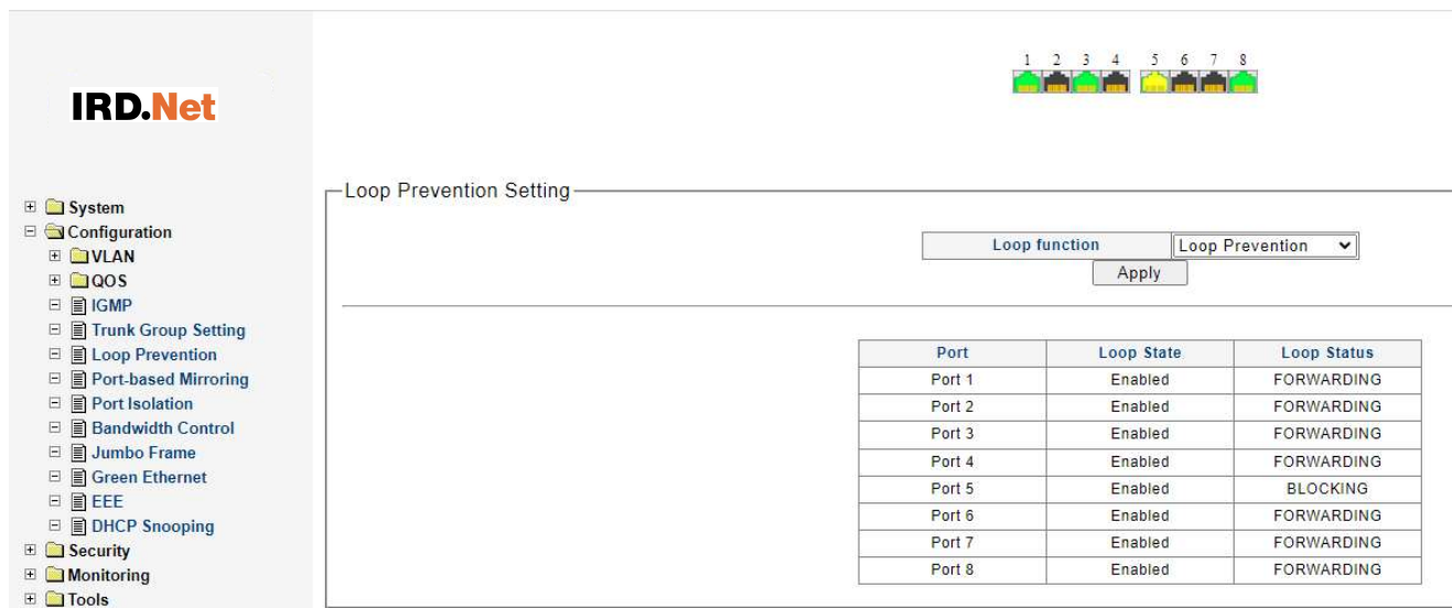
Figura 5-5-2 A porta 5 deste switch foi bloqueada.
