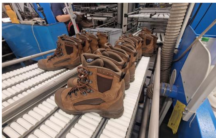
Tiges et semelles de chaussures Haix assemblées avec la méthode AGO ©Virginie Kroun
