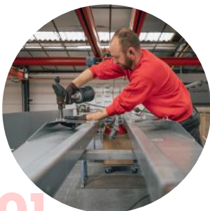
01 Assemblage du châssis et pose du plancher
