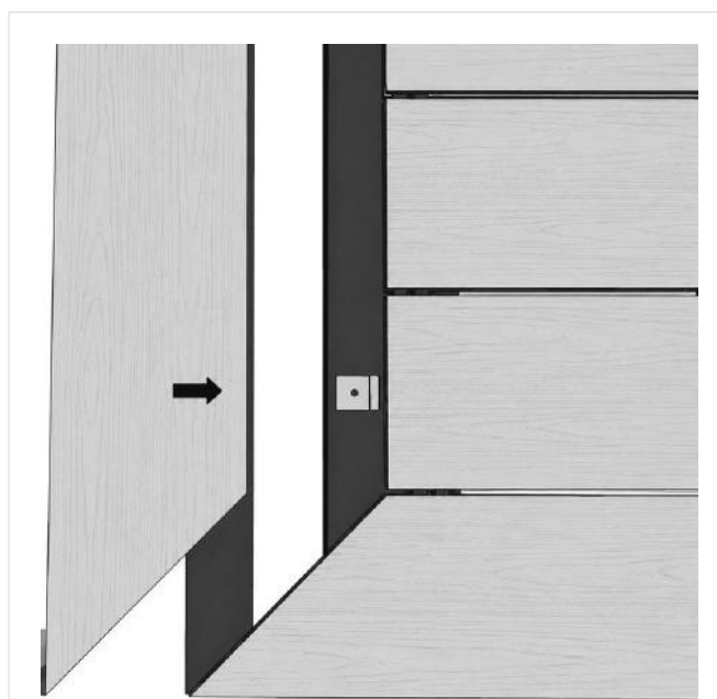
FIG. 15 – TABLA DE CENEFAS PERIMETRALES DESLIZADA DENTRO DE LOS CLIPS DE INICIO
