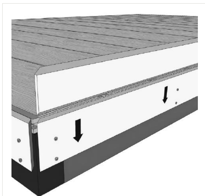
FIG. 25 – PERFIL DE ESQUINA COLOCADO SOBRE EL CANTO DE LA TARIMA
