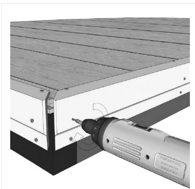
FIG. 26 – PERFIL DE ESQUINA FIJADO CON TORNILLOS AVELLANADOS
