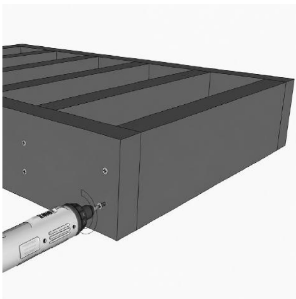
FIG. 27 – CAJÓN CONSTRUIDO PARA SOPORTAR LA ZONA DE PELDAÑOS
