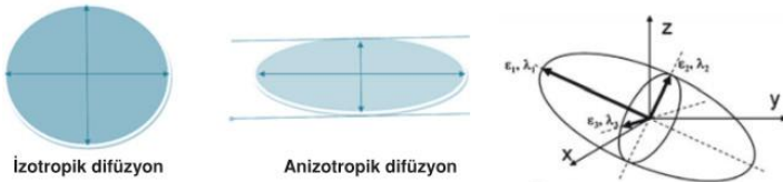
Şekil 32 • Tensör matrisinin elipsoid tarzda şematize edilmesi.
