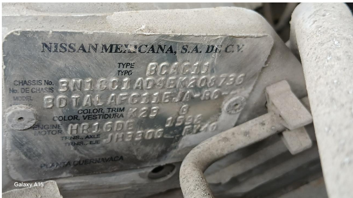
Figura 2. Placa característica del vehículo Nissan Tiida.
