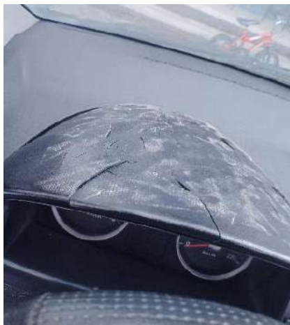
Foto 19: Pintura quemada en toda la carrocería del vehículo.
