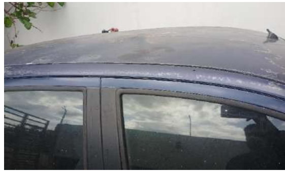
Foto 18: Pintura de techo de carrocería se encuentra quemada en toda la superficie.
