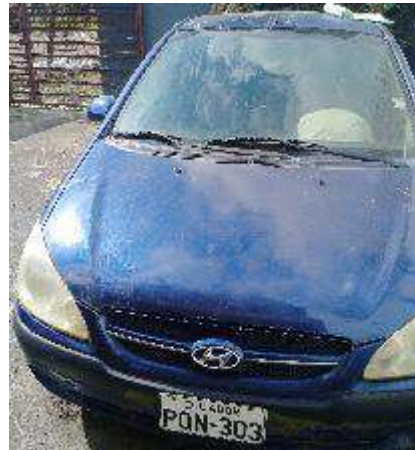
Foto 20: Pintura quemada en capó del vehículo.
