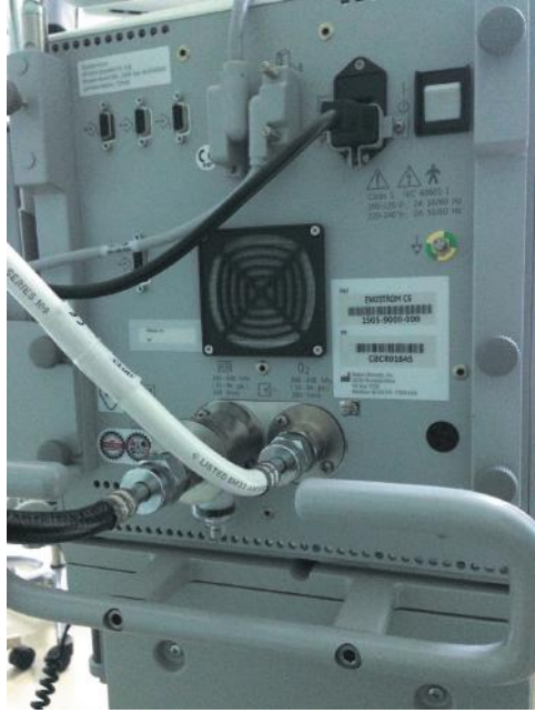
Resim 2: MV güç hava ve oksijen girişleri.
