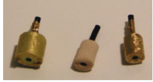
ŞEKİL 5 ♦ ET yöntemi için kullanılan altın folyoya sarılmış ve altın folyodan çıkarılmış halde bulunan iki elektrod modeli.
