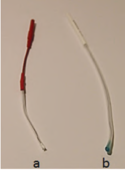
ŞEKİL 3 ♦ TM yöntemi için kullanılan iki elektrod modeli: Tuz ve elektrod jeli içeren küçük fitilli pamuk (a), Fitil hidrojel (b).
