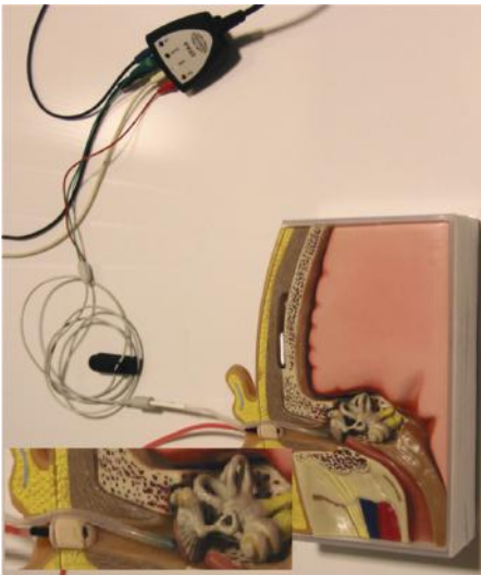
ŞEKİL 4 ♦ TM yöntemi ile ölçüm yapılması için elektrod bağlantıları ve küçük resimde fitil hidrojel bir elektrodun ER-3A insert kulaklık ile yerleşimi.
