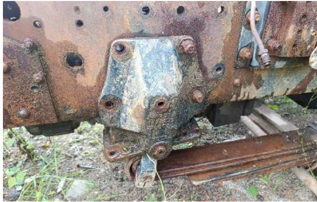
Imagen 10.-fuente directa del vehículo, imagen obtenida por Geovanny Naranjo Cuesta -perito, detalle del motor de los componentes del sistema de suspensión del vehículo inspeccionado.
