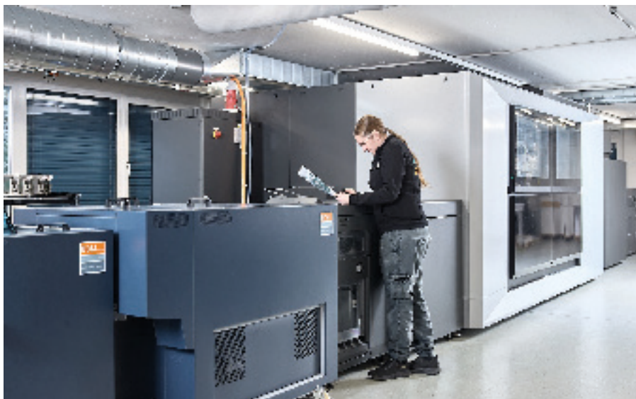
Für die industrielle Digitaldruckproduktion mit Inkjet-Technologie hat Heidelberg die Jetfire 50 im Markt etabliert. In Verbindung mit dem KI gesteuerten Workflow Prinect Touch Free lässt sie sich optimal in eine hybride Produktionsumgebung mit Digital- und Offsetdruck integrieren. ✖ © . Heidelberg
