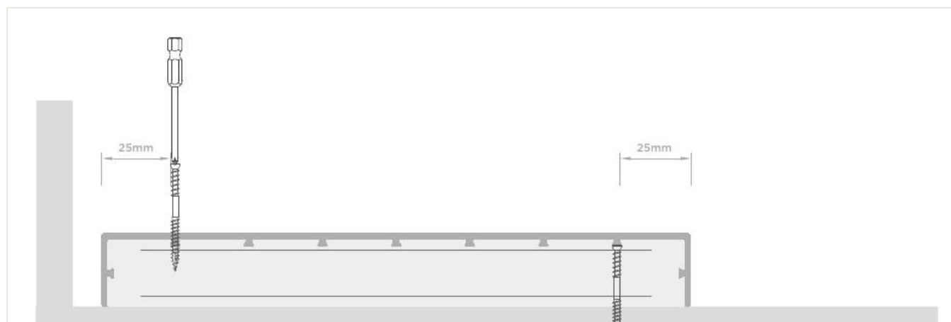
FIG. 1 — PRIMERA TABLA FIJADA POR LA CARA: SEPARACIÓN PERIMETRAL DE 5 MM, TORNILLO HUNDIDO 3–4 MM
