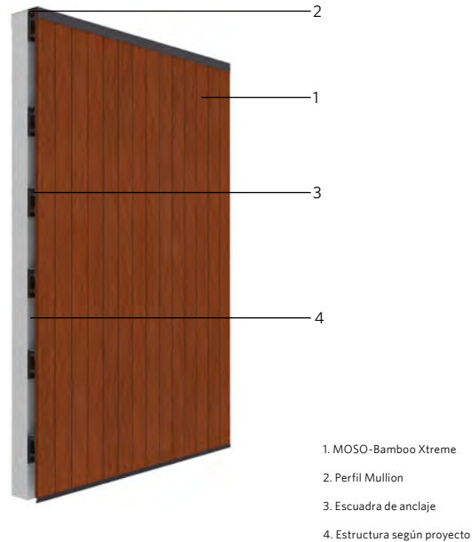
ISOMÉTRICA DEL SISTEMA REVESTIMIENTO
