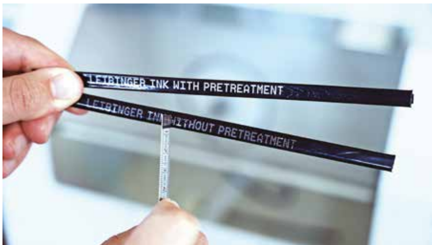
Bei Materialien mit Weichmachern, wie bei Kabelummantelungen, ist die Tintenwahl besonders kritisch: Ist die Haftung nicht stark genug, kann die Kennzeichnung mechanischer Belastung nicht standhalten und lässt sich leicht wieder ablösen.
