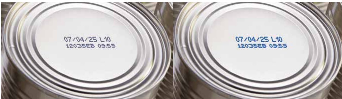
Thermochrome CIJ-Tinten verändern nach erfolgreich abgeschlossener Sterilisation dauerhaft ihre Farbe und machen den korrekt durchgeführten Prozess auf einen Blick sichtbar.
