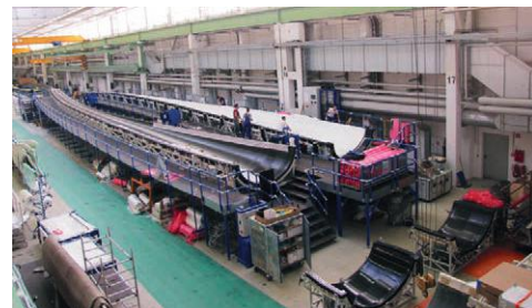
Rotorblattfertigung – zu sehen ist eine Hauptform des Typs E115-1 in einer der Werkhallen in Magdeburg-Rothensee
