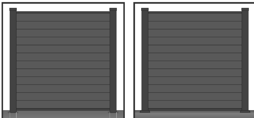
FIG. 1 – INSTALLATIEOPTIES – BETONFUNDERING (LINKS) EN VOORBEREIDE FUNDERING (RECHTS)
