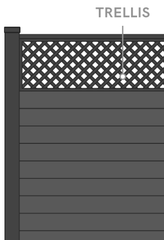
FIG. 2 – AFGEWERKTE OMHEINING MET LATWERK AAN DE BOVENZIJD
