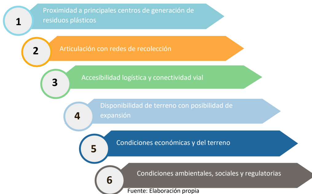
Figura 8. Condiciones logísticas y de terreno para la planta de reciclaje químico
