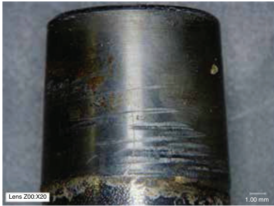
ŞEKİL 2 Sürtünme ve korozyon nedeniyle hasar görmüş bir stem trunnionu gösteren ışık mikroskobu fotoğrafı (solda) ve kalan trunnionun hasarsız bir kısmının yanı sıra sürtünme ve korozyon hasarını gösteren tipik bir taramalı elektron mikroskobu fotoğrafı. (sağda)
