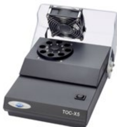
TOC-X5 TOC-Rüttler zur Spülung des anorganischen Kohlenstoffs (TIC) für die Bestimmung des TOC mit LCK385, LCK386 und LCK387.
