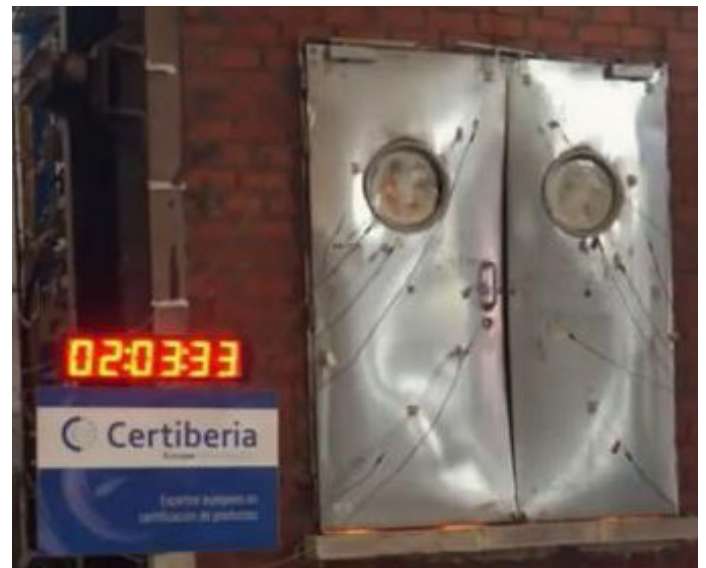
Ensayo resistencia al fuego de puerta de 2 hojas 1800 x 2200 mm con mirillas →
