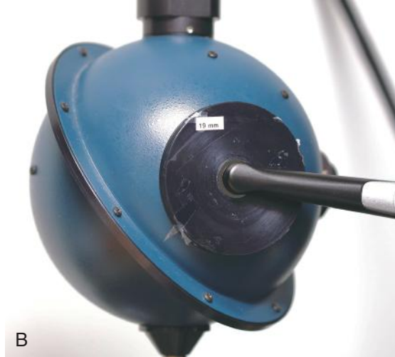
• Şekil 7.31 (A) Şematik diyagram ile ilgili A spektrometre. 1. Fiber optik bağlayıcı. 2. Değiştirilebilir giriş yivi. 3. uzun geçiş filtresi 4. Kollimasyon ayna. 5. Elek. 6. Fokus aynası. 7. Koleksiyon lense 8. Dedektör. 9. Değişken uzun geçiş filtresi. 10. Ultraviyole dedektör penceresi. (Şekil Ocean Optiğin katkılarıyla.) (B) Spektrometreye bağlı entegre kürenin girişinin üzerindeki ışıkla sertleştirme ünitesinin örneği .
