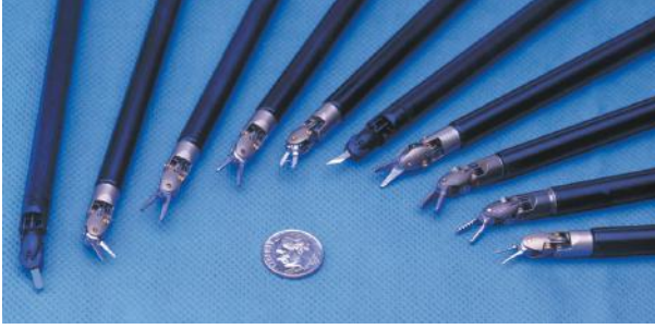
Şekil 9-23. da Vinci Robotic sistemin 8 mm'lik değiştirilebilir aletleri.
