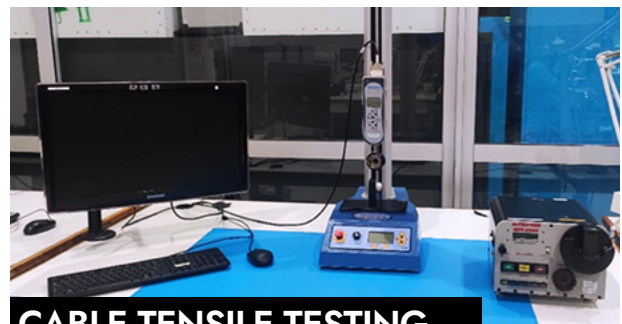
CABLE TENSILE TESTING MACHINES (PULL TEST)
