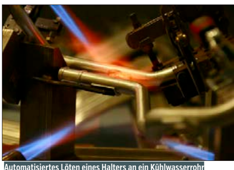
Automatisiertes Löten eines Halters an ein Kühlwasserrohr
