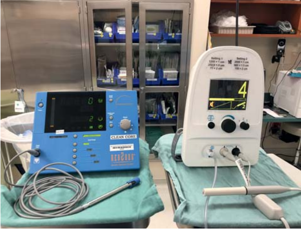
ŞEKİL 8 İyot-125 tohumları tespit edebilen Neoprobe tohum dedektörü (solda) ve Magseed dedektörü (sağda), prob görünümü ile . Hangi prob kullanılırsa kullanılsın, yara asepsisini korumak için prob plastik bir kılıf içine yerleştirilir.
