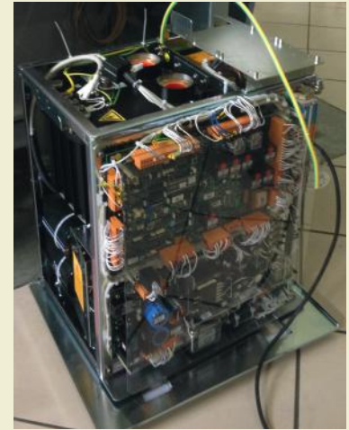
ŞEKİL 1.7. Kurulum sırasında bir röntgen makinesi jeneratörünün görüntüsü. ▶
