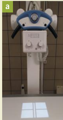
ŞEKİL 1.9. Değişken açıklıklı kolimatör. Kolimatörün röntgen tüpüne takılı ön yüzü ve içerisindeki ışık kaynağı tarafından aydınlatılan masa alanı, seçilen X ışınlarının boyutuna karşılık gelir (A). Kolimatörün alt kısmında, ışık kaynağı ve ışın boyutunu ayarlamaya olanak tanıyan iki/iki paralel kurşun şeritler (B).
