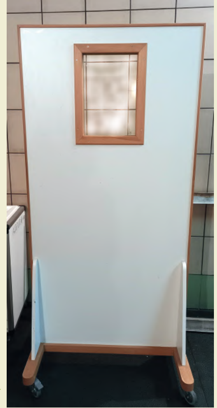
ŞEKİL 1.34. Küçük kurşun cam pencere ile radyasyon koruma bölmesi. ▶
