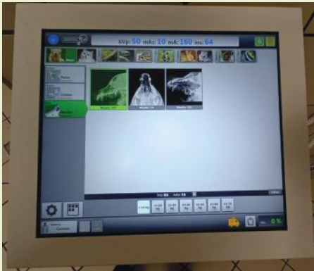
ŞEKİL 1.8. Işınlama parametrelerinin bir bilgisayar programı ve dokunmatik ekran monitörü kullanılarak seçildiği dijital kontrol paneli.
