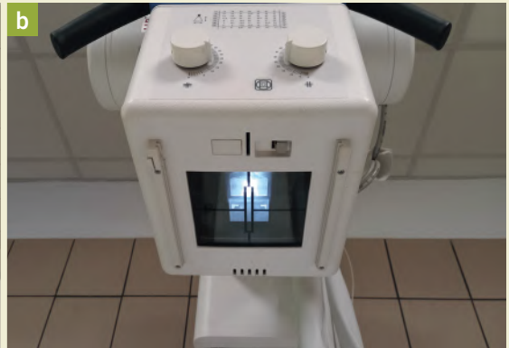
ŞEKİL 1.9. Değişken açıklıklı kolimatör. Kolimatörün röntgen tüpüne takılı ön yüzü ve içerisindeki ışık kaynağı tarafından aydınlatılan masa alanı, seçilen X ışınlarının boyutuna karşılık gelir (A). Kolimatörün alt kısmında, ışık kaynağı ve ışın boyutunu ayarlamaya olanak tanıyan iki/iki paralel kurşun şeritler (B).
