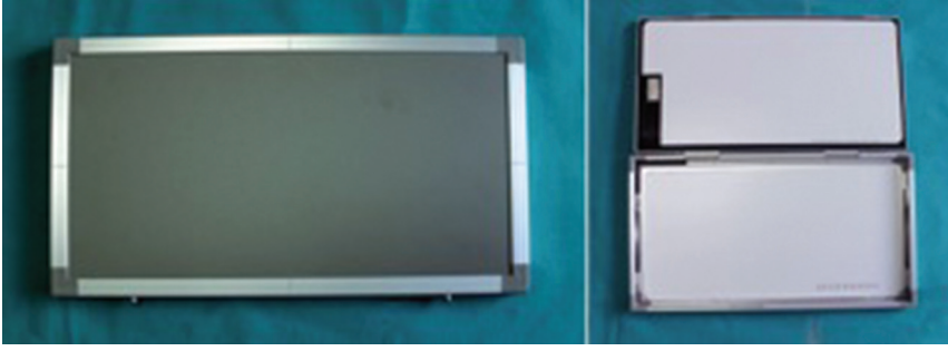
Resim 11 • Ekstraoral görüntülemelerde kullanılan Intensifying screen kasetler (kapalı ve açık).
