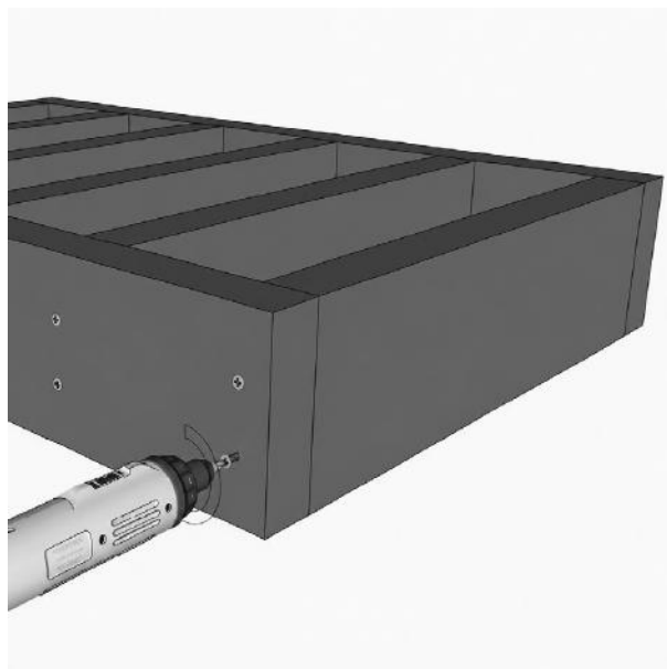
FIG. 27 — KADERFRAME GEBOUWD OM HET TREDENGEBIED TE ONDERSTEUNEN
