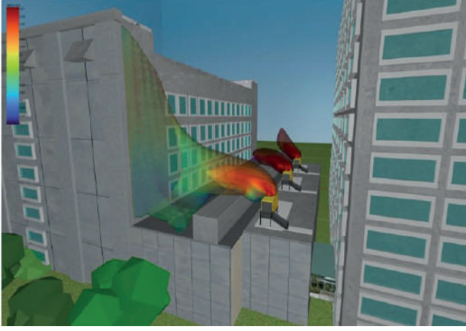
*Şekil 1: Sabit hızla sahip izoyüzeyler ve değişken karbon monoksit seviyeleri
