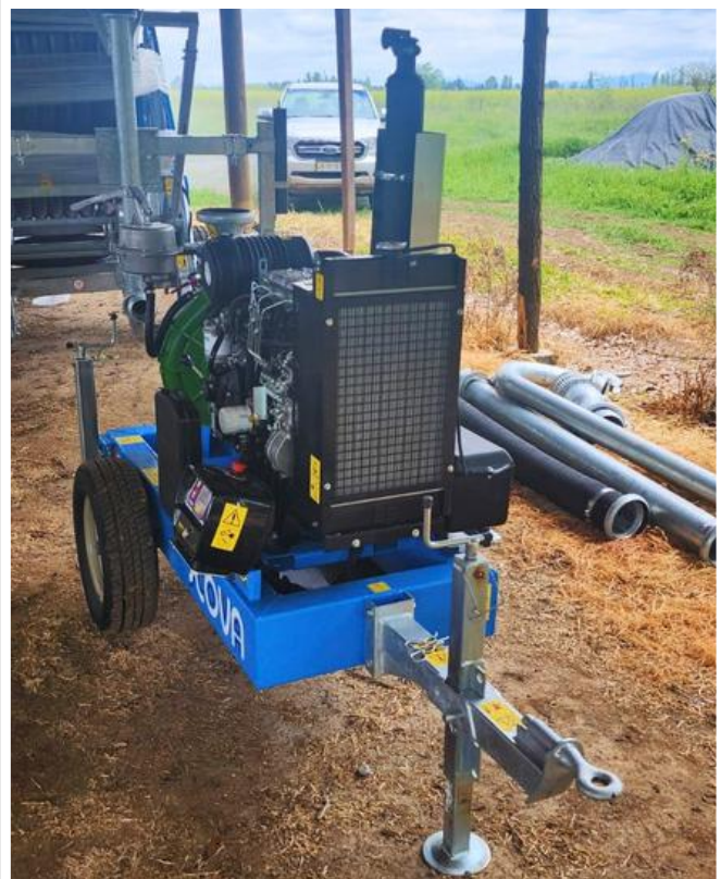
Foto: Motobomba diesel para impulsión de carrete de riego. Proyecto adjudicado a nuestra regante ACM, Maricel Vilches.
