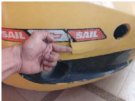
Parachoques delantero roto
