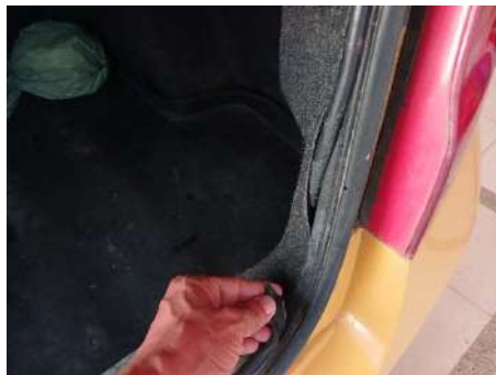
Cauchos de puertas rotos
