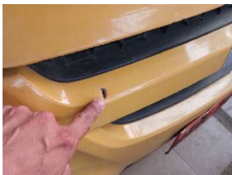
Perforación local en parachoques delantero
