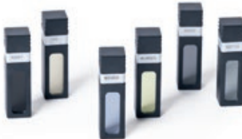
Комплект тестови филтри за вътрешен контрол на качеството и валидиране на DR спектрофотометри. Състои се от филтри за проверка на точността на абсорбцията, разсеяната светлина и точността на дължината на вълната.
