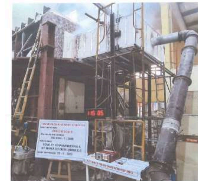
Ảnh C.9: Mẫu thử tại thời điểm phút thứ 116 của quá trình thử nghiệm
