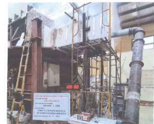
Ảnh C.10: Mẫu thử tại thời điểm phút thứ 120 của quá trình thử nghiệm
